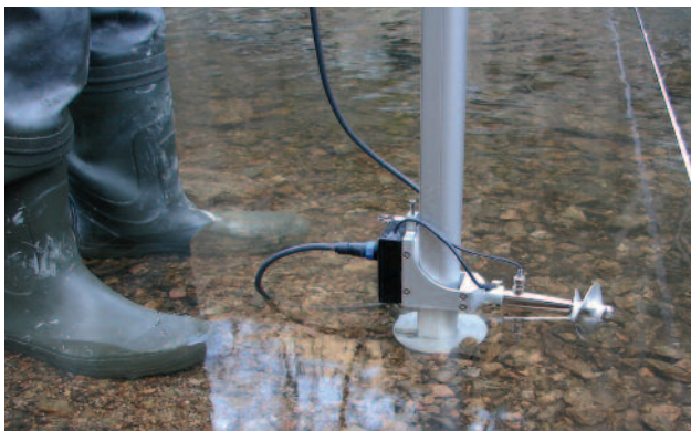
Jaugeage au moulinet : travaux pratiques de courantométrie
