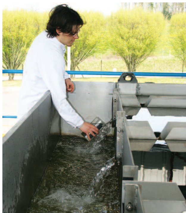
Prélèvement d'eau sur pilote de traitement d'eau potable
