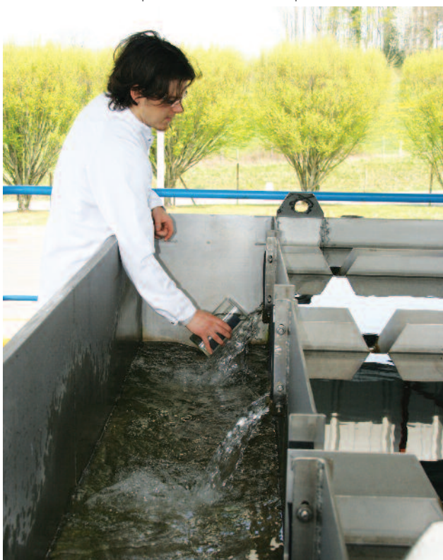
Prélèvement d'eau sur pilote de traitement d'eau potable
