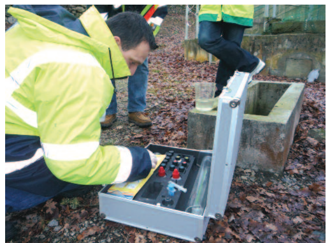
Analyses de terrain sur station à boues activées
