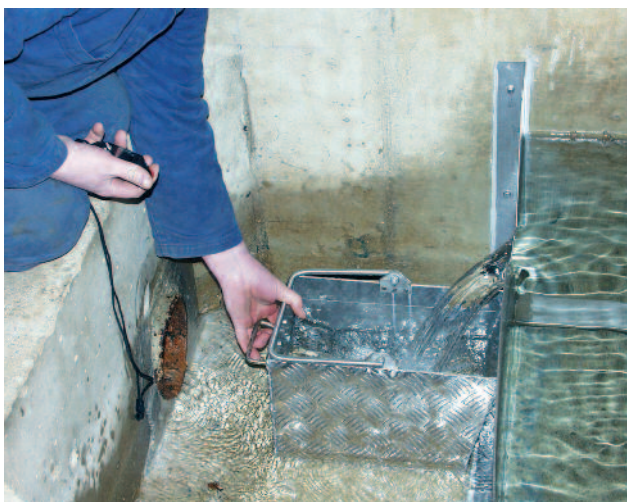
Mesure de débit sur captage d'eau
