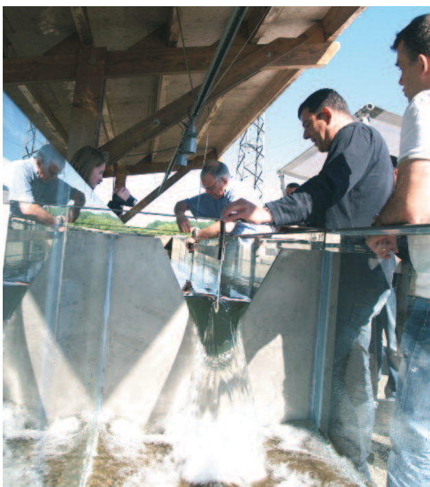
Mesure de débit en canal ouvert
